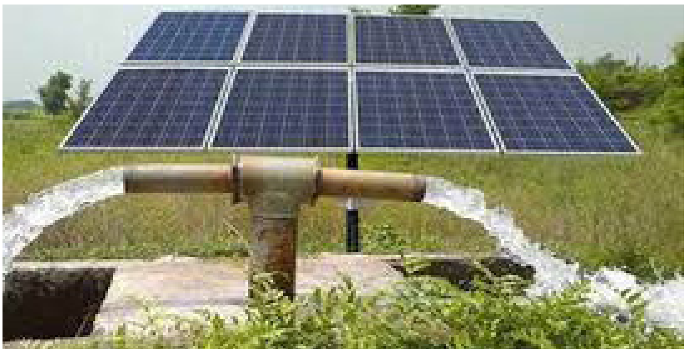
चित्र : सिंचाई के लिए सौर फोटो वोल्टाइक (SPV) सिंचाई पंप
